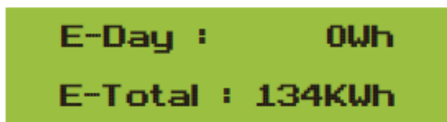
Kuva 8.1.6 E-Day : Päivittäinen tuotanto; E-Total : Kokonaistuotanto.
