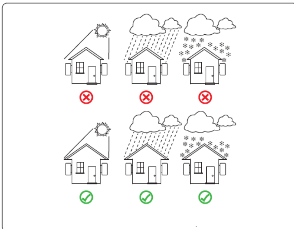
Kuva 4.1.1 Invertterin suositellut asennuspaikat rakennuksen julkisivulla.
