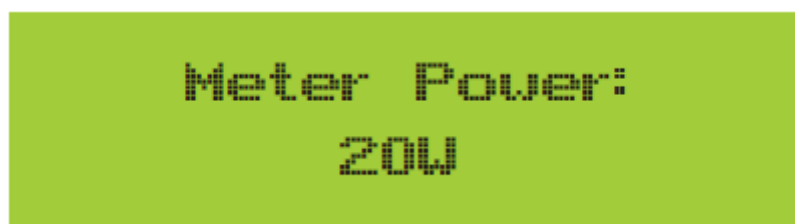
Kuva 7.2.3 Nollaviennin toiminto energiamittarin kautta päällä.
