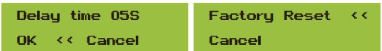
Kuva 8.3.4 Viiveajan asetus, sekä tehdasasetusten palautus.
