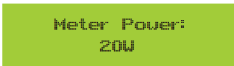
Kuva 7.2.3 Nollaviennin toiminto energiamittarin kautta päällä.
