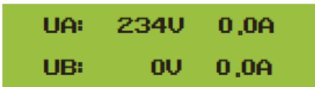
Kuva 8.1.4 Verkon jännite- ja virtatiedot.
