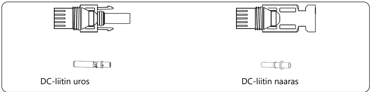
Kuva 5.2.4 Havainnekuva tasavirtapuolen uros- ja naaraspuolen liittimistä.
