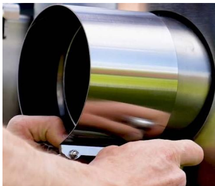
Joonis 15: Ühenduskinnituse kinnitamine ahju otsikule
