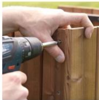
Kuva 20: Toimitettujen osien laajuus, seinien kiinnittäminen ruuveilla, kannen asettaminen
