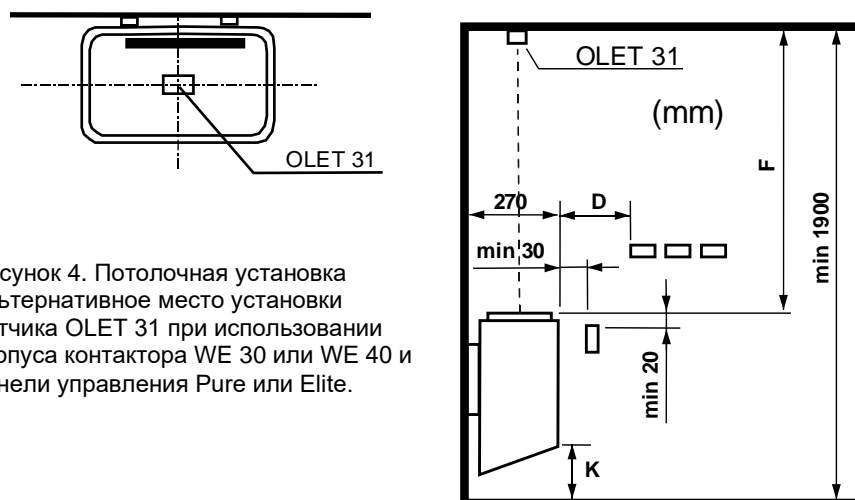
Рисунок 3 Безопасные расстояния и положение датчика
